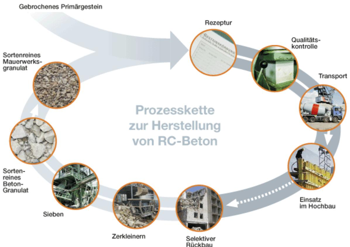
Abbildung 6: Herstellungsprozess von RC-Beton ([www.rc-beton.de/herstellung.html](http://www.rc-beton.de/herstellung.html)), 26.04.2017
