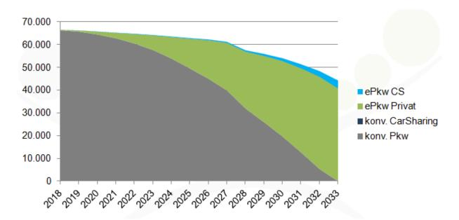
Das zu erarbeitende Ladeinfrastrukturkonzept wird an dem zukünftigen Fahrzeugbestand im Landkreis Gießen ausgerichtet. Hierbei werden für den Zeithorizont von 15 Jahren unterschiedliche Szenarien unter verschiedenen Annahmen berechnet. Die Abbildung zeigt beispielsweise ein vergleichbares Projektbeispiel aus Süddeutschland. In diesem Szenario wird beispielsweise ab 2027 ein verstärkter Einsatz von autonomen Fahrzeugen erwartet.
